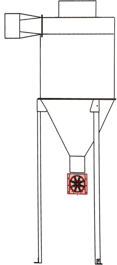
تأثير قوة الطرد المركزي من كهربائي معين في المنتج مع جزيئات الغبار وتنقية الهواء في بيئة العمل ، أو المعدات أو المرافق التي يمكن تخزين شفت الأعاصير التي تخلق الفرق في المعنى حسب وضع النظام.
